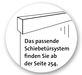
Eine Bürste schließt die Tür zum Boden ab.
